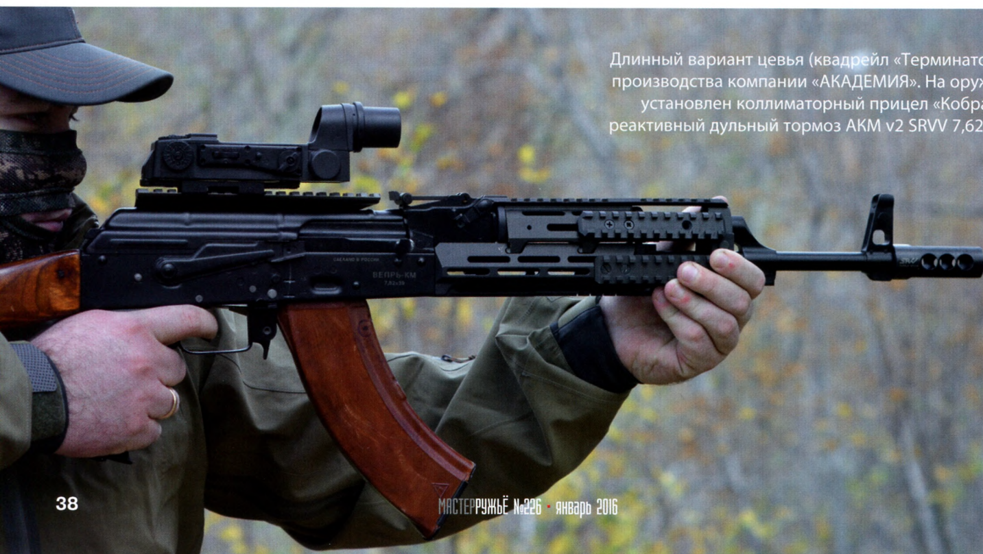
Установка короткого дюралевого квадрайла «Сerpент» производства «АКАДЕМИЯ» на ВПО-136 (АКМ)
