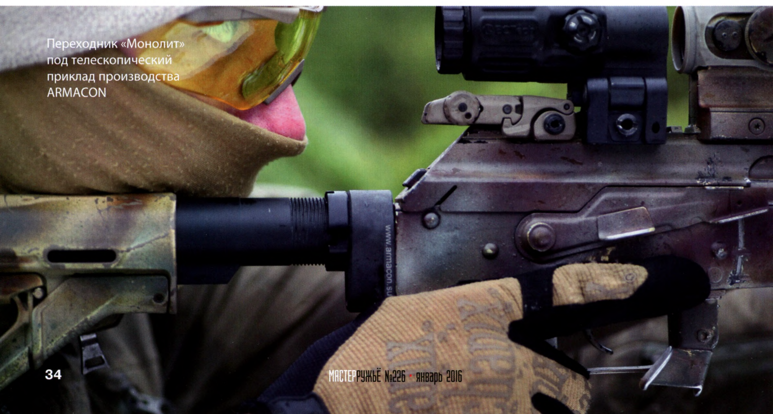
Установка вкладыша для телескопического приклада
