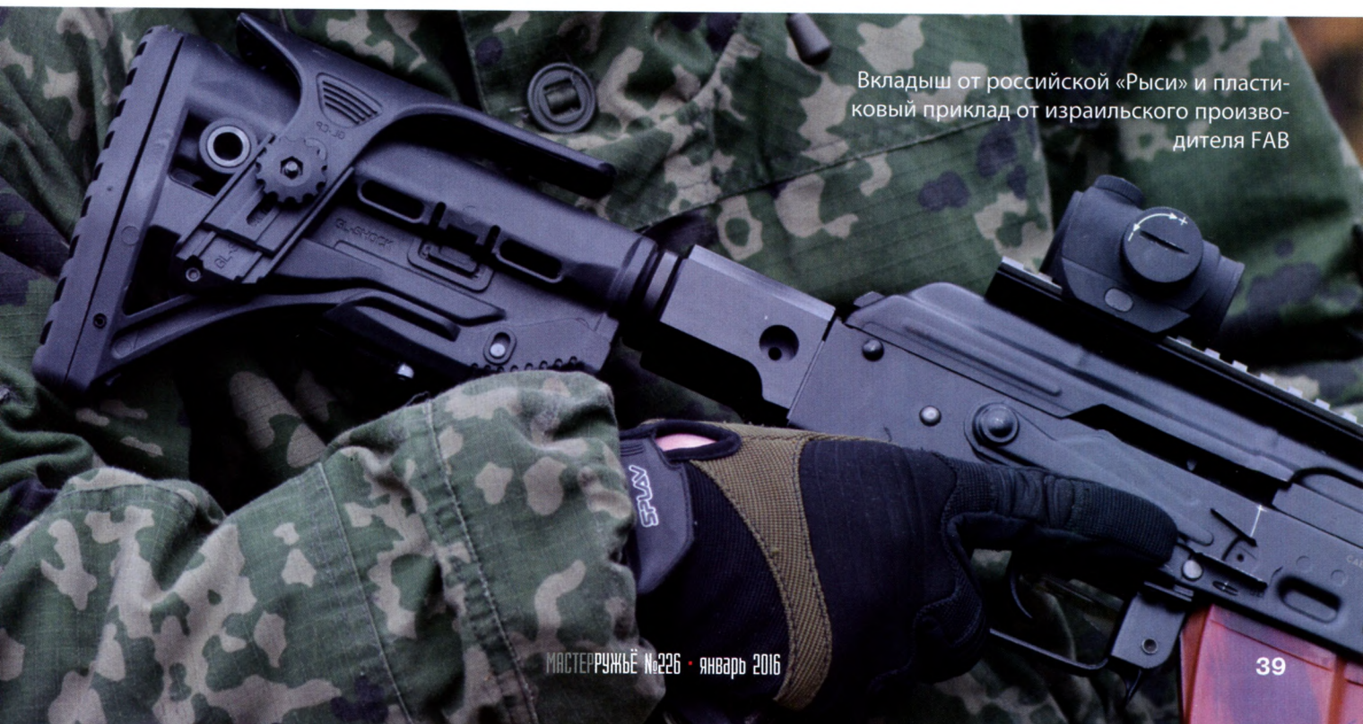
Варианты вкладышей (нормальная и повышенная ось) в ствольную коробку АК под телескопический приклад производства компании «Рысь»
